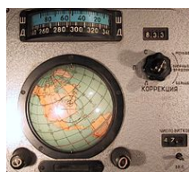
Система «Глобус» на борту космического корабля «Восход»
